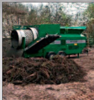
■ Die mobile Siebtrommel bearbeitet den Boden direkt auf dem Grundstück.
