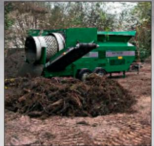
■ Die mobile Siebtrommel bearbeitet den Boden direkt auf dem Grundstück.
